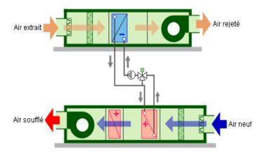
L'installation pulse et extrait de l'air dans les différentes zones du restaurant au moyen de monoblocs.
